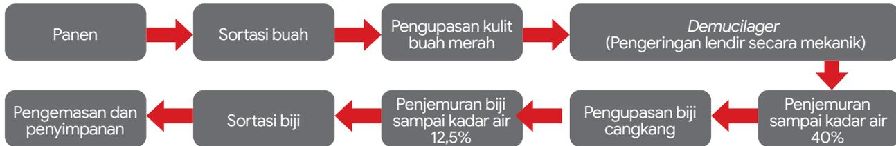
Gambar 26: Proses semi basah untuk biji kopi labu
