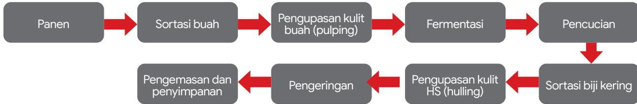
Gambar 24: Tahapan proses basah (full washed) pada buah kopi
