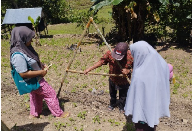
Figure 18. Membuat garis kontur menggunakan bingkai A
