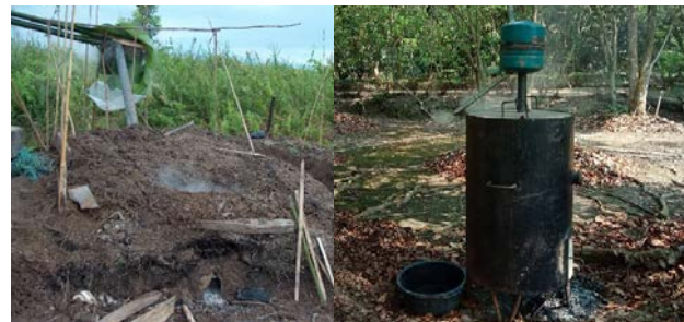
Figure 14. Pembuatan biochar di dalam tanah atau di dalam tanur (tungku)
