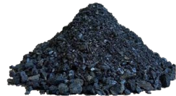
Figure 13. Biochar hasil dari pirolisis biomassa sisa PLTB
