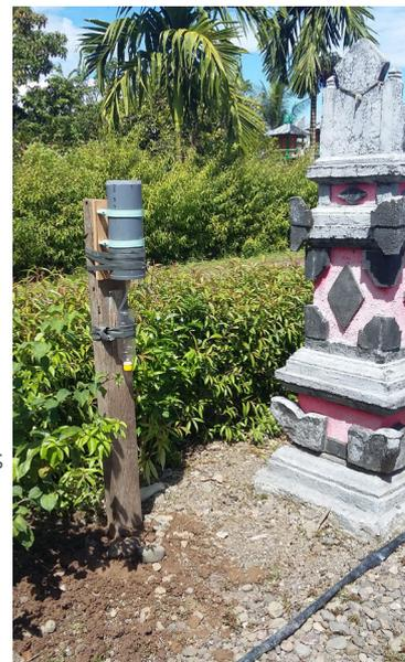
**Gambar 3.** Alat penakar curah hujan dengan menggunakan PVC (kiri), ilustrasi cara pemasangannya (tengah), alat yang sudah terpasang (kanan)
