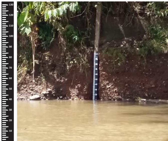
**Gambar 1.** Plat besi meteran tinggi muka air yang dipasang di pinggir sungai
