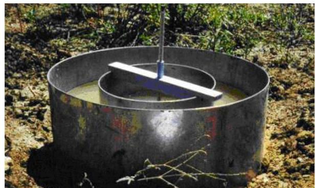
*Double ring* atau silinder ganda untuk pengukuran laju infiltrasi
