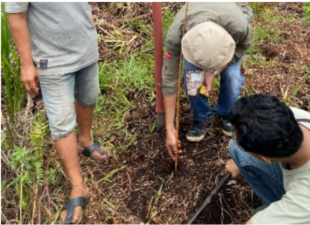
Gambar 6. Pengukuran subsiden dan pengambilan contoh gambut di lapangan
