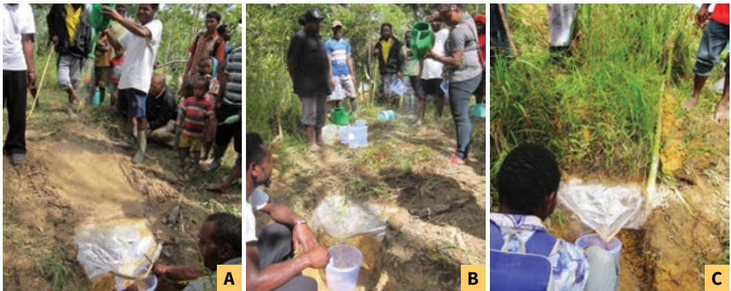
Gambar 7. Proses penyiraman petak erosi dan penampungan air aliran dari petak (foto: Universitas Brawijaya/Kurniatun Hairiah)
