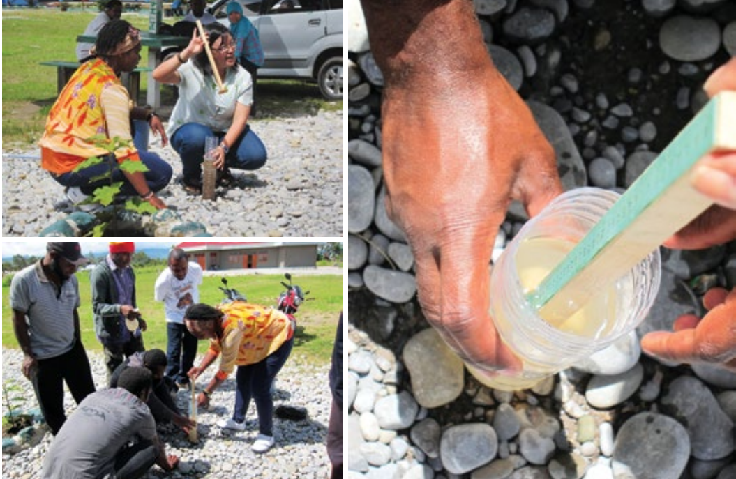
Gambar 22. Proses pengukuran kekeruhan air (foto: Universitas Brawijaya/Kurniatun Hairiah)
