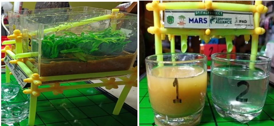
Gambar 5 Alat peraga pencegahan erosi tanah dengan penambahan tanaman penutup tanah.
