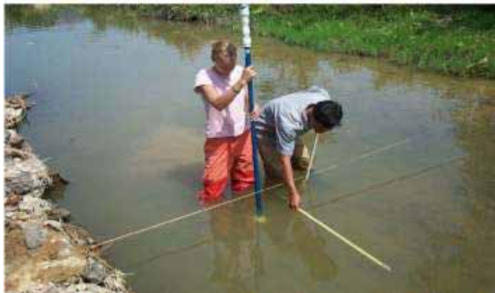
Gambar 2.4. Pengukuran profil sungai dan pengukuran kecepatan aliran sungai dengan menggunakan flow probe (Foto: Maria Arweström)
