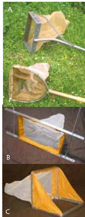
Gambar 4.2. Jaringan untuk mengambil contoh makroinvertebrata; (A) Drift net sampler untuk melakukan 'kick sampling' dan (B) Drift net sampler untuk di pasang di dasar sungai; (C) Surber sampler net (Foto: Andy Dedecker dan Ans Mouton (gambar A); www.pearce-environment.co.uk/acatalog/Pond_Eq... (gambar B dan C))
