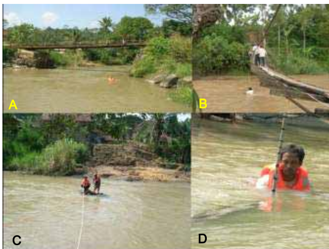
Gambar 2.1. Proses pembuatan profil sungai, (A) jembatan adalah salah satu lokasi yang ideal untuk mengukur debit; (B) pengukuran kedalaman sungai tiap interval; (C) tali dan (D) tongkat pengukur digunakan sebagai alat ukur manual (Foto: ICRAF-Sumberjaya arsip)
