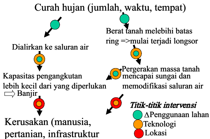
Gambar 5.9. Diagram sebab-akibat yang menghubungkan antara curah hujan dengan dampak yang mungkin ditimbulkan bagi manusia. Tahapan yang terjadi melibatkan perubahan penutupan/penggunaan lahan, penerapan teknologi yang mempengaruhi sistem drainase dan penyimpanan air (dalam lanskap) dan lokasi kegiatan manusia (perkotaan/perumahan) berlangsung.
