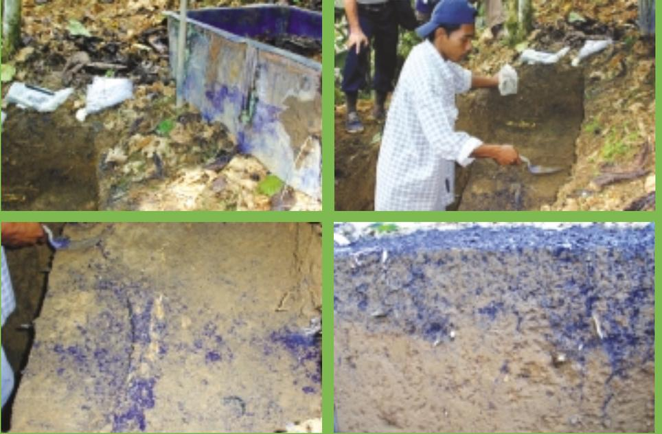
Gambar 18: Kegiatan pengukuran jumlah pori makro di lapangan menggunakan larutan *methylen blue* (keterangan searah jarum jam) cairan disiramkan ke dalam bingkai plastik sekitar 6 jam sebelum pengamatan (Atas kiri), lapisan tanah dipotong per kedalaman 10 cm (Atas kanan), Sebaran bercak biru menunjukkan sebaran pori makro tanah pada bidang horizontal (bawah kiri), sebaran pori makro tanah pada bidang vertikal (bawah kanan). (Foto: Meine van Noordwijk & Kurniatun Hairiah).
