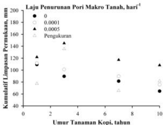
Gambar 7. Perbandingan hasil pengukuran limpasan permukaan di lapangan dengan hasil simulasi pada nilai SKD 0; 0.0001 dan 0.0005.
