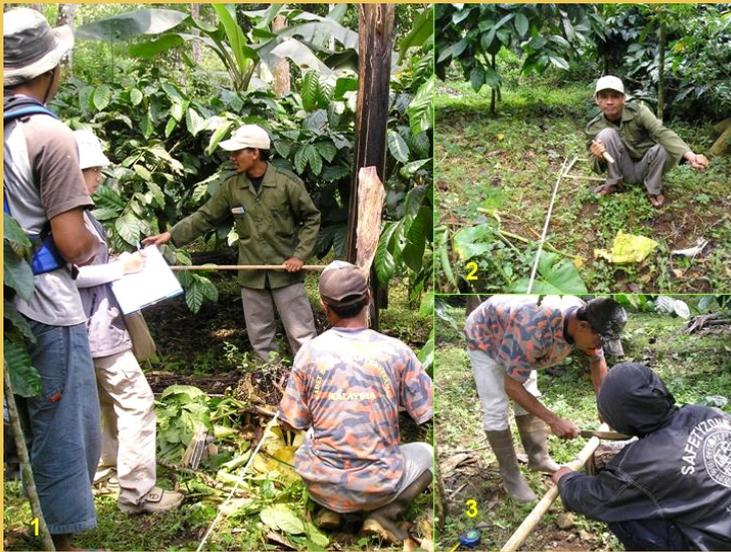
Foto 2. Pembuatan SUB-PLOT pengukuran penyimpanan C pada sistem agroforestri berbasis kopi, (1 dan 2) Pengukuran SUB-PLOT 5 m x 40 m, (2) Pembuatan siku SUB-PLOT, (3) Pemberian patok di sudut plot sebagai tanda bila plot akan dijadikan plot permanen.
