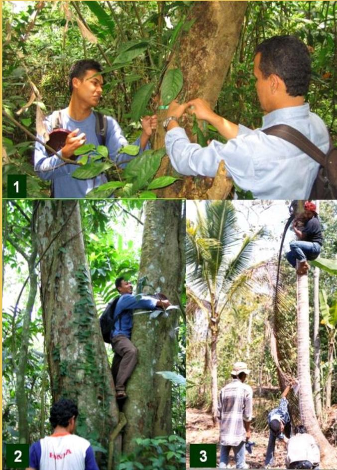
Foto 3. Pengukuran diameter batang (dbh) pohon: (1) pengukuran dbh pohon besar di hutan, (2) pengukuran dbh pohon bercabang, percabangan terjadi pada ketinggian  $< 1.3$  m dari permukaan tanah, (3) pengukuran diameter batang pohon kelapa
