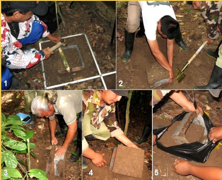
Foto 9. Pengambilan contoh tanah utuh, (1) pembenaman ring besi ke dalam tanah, (2) pemotongan tanah di sekitar ring dan pengangkatan ke luar lubang, (3 dan 4) memotong kelebihan tanah pada ring hingga rata dengan permukaan ring, (5) memasukkan contoh tanah ke dalam kantong plastik dan pemberian label contoh tanah yang diambil.
