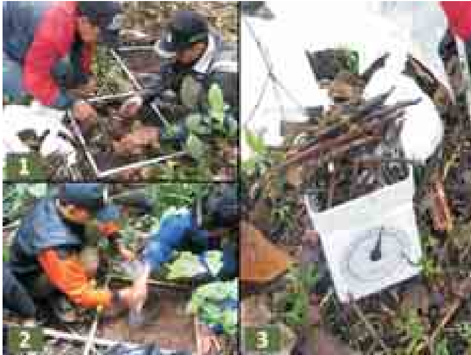
Foto 8. Pengukuran nekromasa tidak berkayu, (1) seresah di permukaan tanah, (2) pengambilan contoh tanah terganggu di lapisan atas, (3) penimbangan berat basah langsung di lapangan
