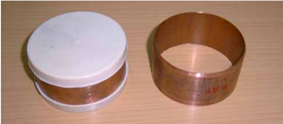
Gambar 10. Ring untuk pengambilan contoh tanah utuh; dengan penutup dan tanpa penutup ring. Ukuran ring yang biasa digunakan adalah, diameter 5 cm atau 7,5 cm dan tinggi antara 2,5-6,0 cm. Ring berdiameter kecil menyebabkan lebih banyak kerusakan contoh tanah.
