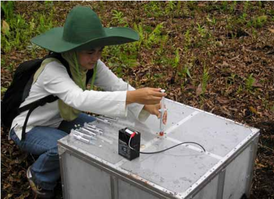
Gambar 19. Pengambilan contoh gas dari sungkup tertutup ( closed chamber ) untuk selanjutnya diukur dengan gas chromatography .
