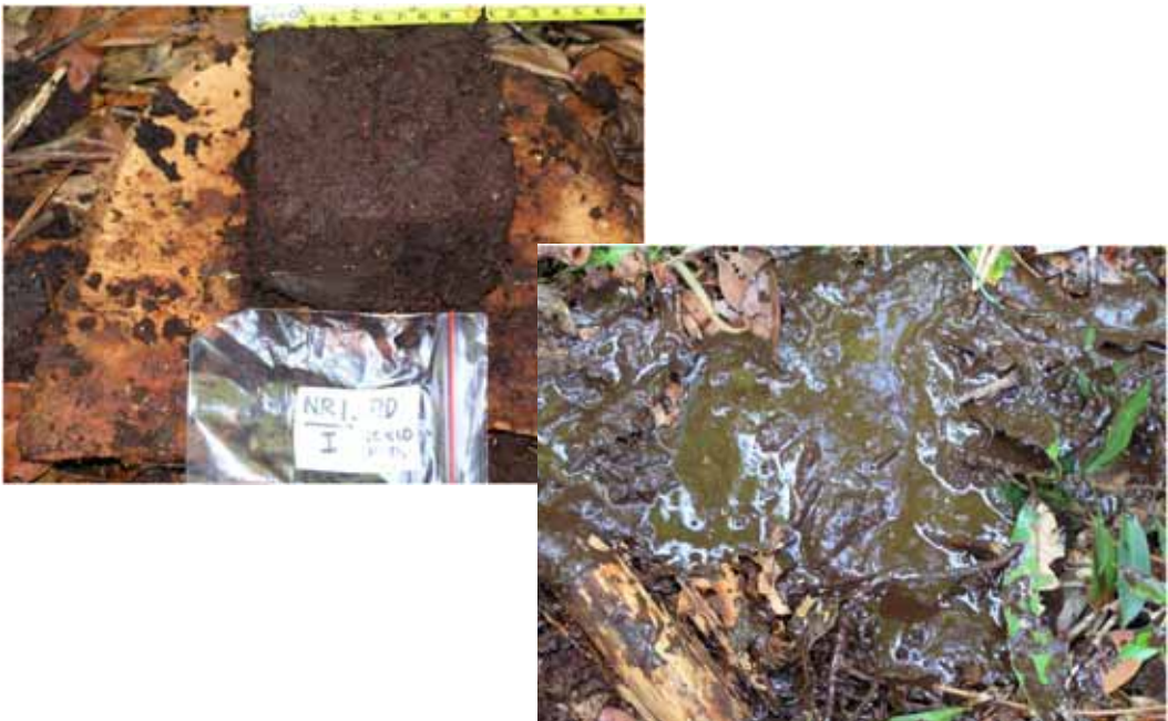
Gambar 12. Contoh gambut berbentuk kubus (kiri) dan contoh gambut yang mencair karena diambil dengan bor Eldeman dari kedalaman di bawah muka air tanah (kanan).
