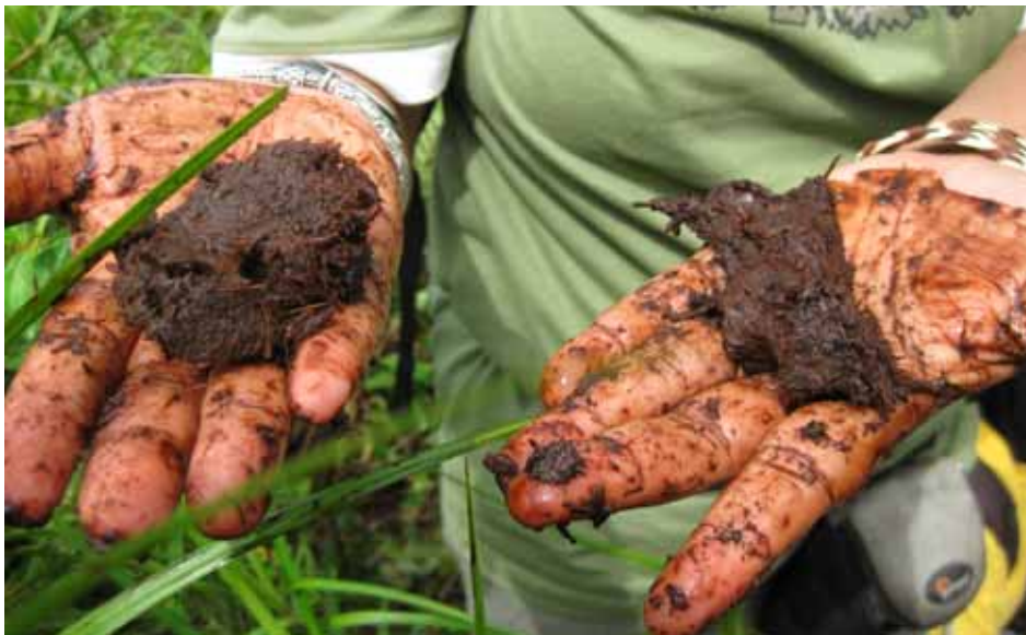
Gambar 16. Penentuan kematangan gambut di lapangan dengan cara meremas segenggam contoh di kepalan tangan. Contoh pada tangan kanan berkematangan fibrik dan pada tangan kiri berkematangan hemik.
