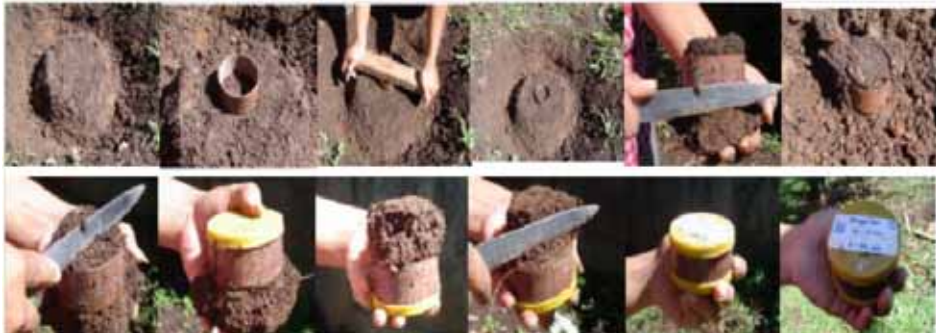
Gambar 11. Tahapan pengambilan contoh tanah utuh menggunakan ring kuningan (dari pojok kiri atas ke pojok kanan bawah).
