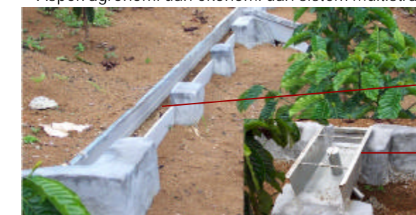
Gutter dan 'Chino' meter untuk mengukur erosi dan aliran permukaan
