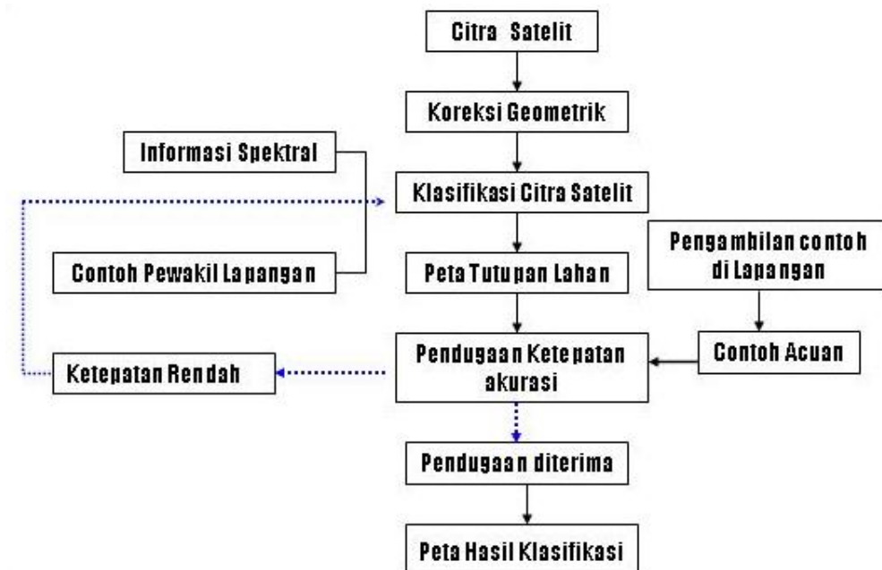
Gambar 2. Diagram alur analisis penutupan lahan dari citra landsat yang dilakukan pada PCH di DAS Talau (Sumber: Jeanes, et al., 2004).
