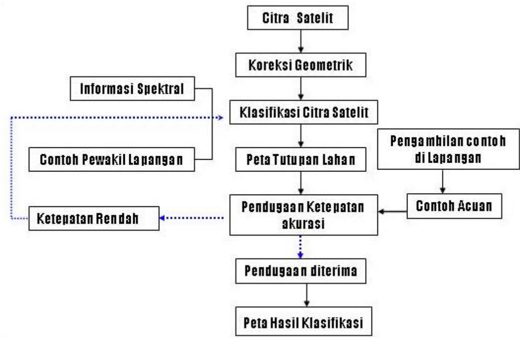
Gambar 2. Diagram alur analisis penutupan lahan dari citra Landsat yang dilakukan pada PCH di DAS Kapuas Hulu (Sumber: Jeanes, et al. , 2004).
