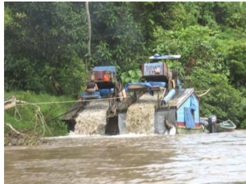
Gambar 13. Penumpukan sampah kayu di tepi sungai menyebabkan tidak stabilnya debit sungai (kiri). Penambangan emas semi mekanik di tepian sungai menambah kekeruhan dan polusi di sungai (kanan)
