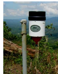
Gambar 4. Penakar Curah Hujan Otomatis.
