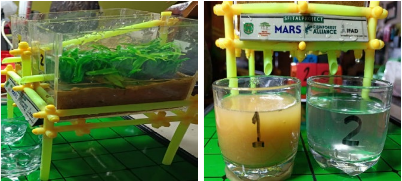
Gambar 5. Alat peraga pencegahan erosi tanah dengan penambahan tanaman penutup tanah.
